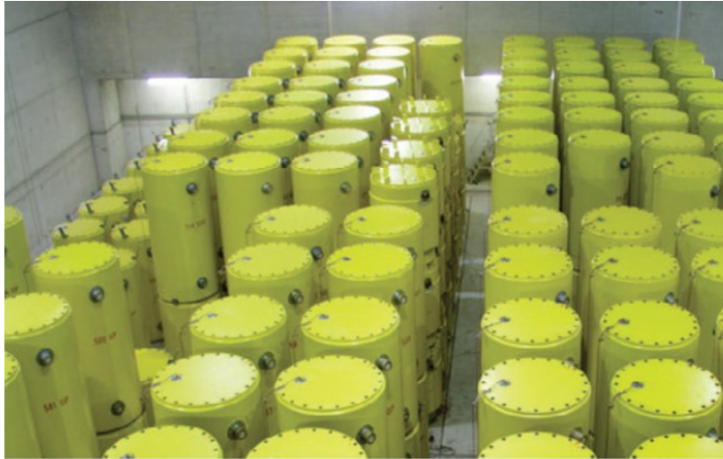
Abbildung 10: Gelagerte Behälter des Typs CASTOR THTR/AVR im BZA
